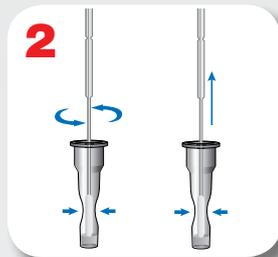
Die Probe wird durch Rotationsdrehung im Extraktionspuffer gelöst. Anschließend kann das Teststäbchen wieder entnommen werden.
